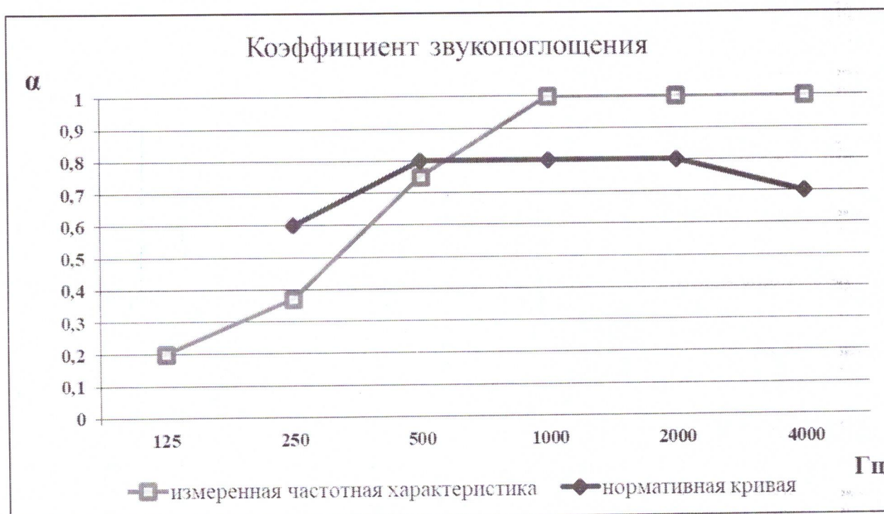
Рис.1. Коэффициент звукопоглощения материала «Foampipe Acoustics (Luxe)», классифицированное по классу «В».
