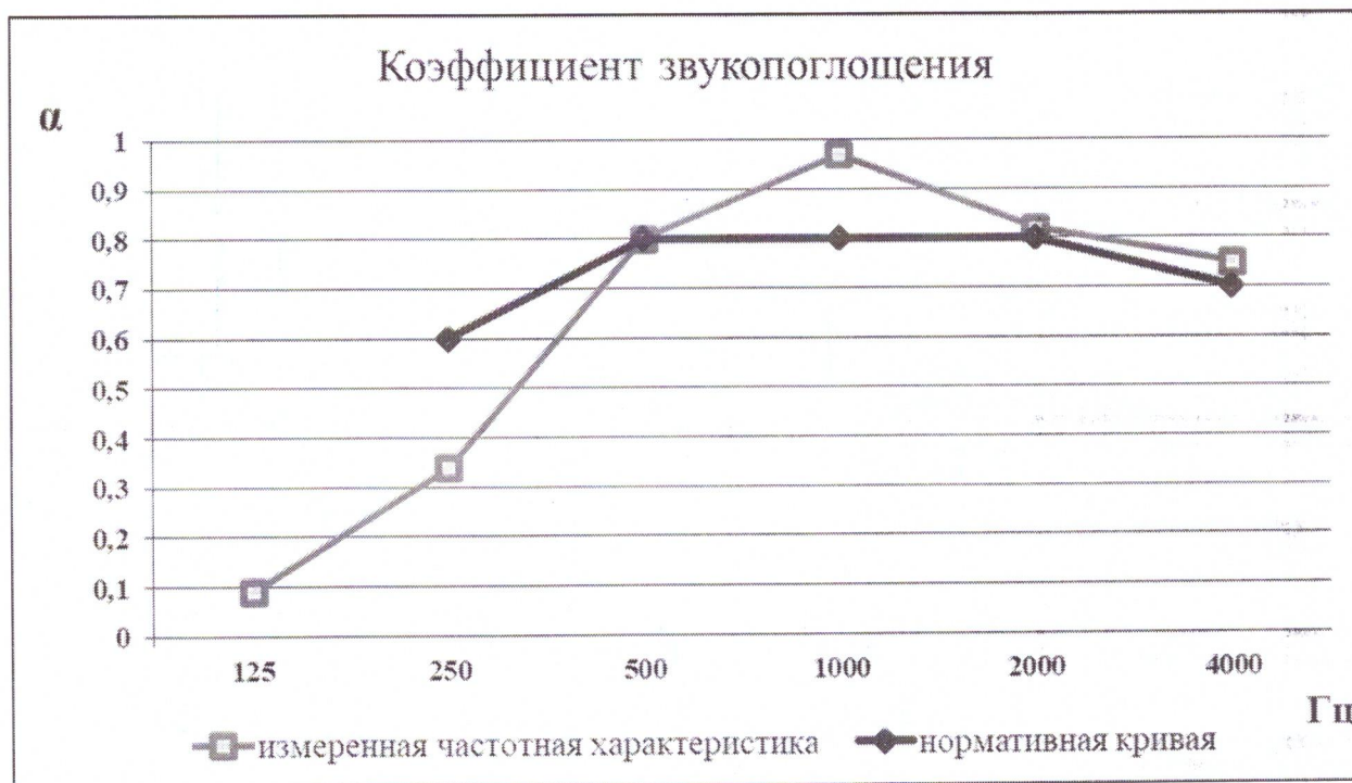
Рис.2 Коэффициент звукопоглощения материала «Shumasil Floor», классифицированное по классу «В».
