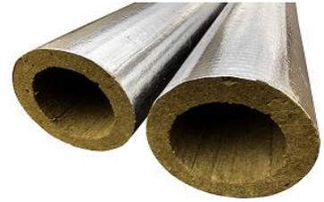
Теплоизоляционные цилиндры **Shumasil SM105ALU** кашированные фольгой для изоляции трубопроводов с температурой носителя -160 до +550°C
