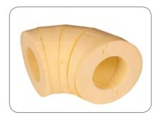
Отвод «FOAMPIPE SEWER EL» производится с максимальной точностью из нескольких сегментов, которые легко собираются одним человеком за несколько минут. Сегменты можно плотно прижать друг к другу или зафиксировать при помощи полиуретанового клея или закрепить при помощи обычной вязальной проволокой.
